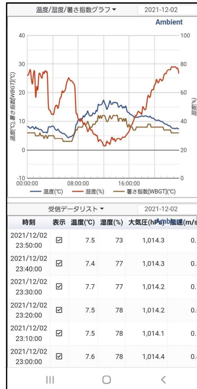
リアルタイム監視画面 (スマートフォン) (IoTクラウドサービス「Ambient」利用時)
