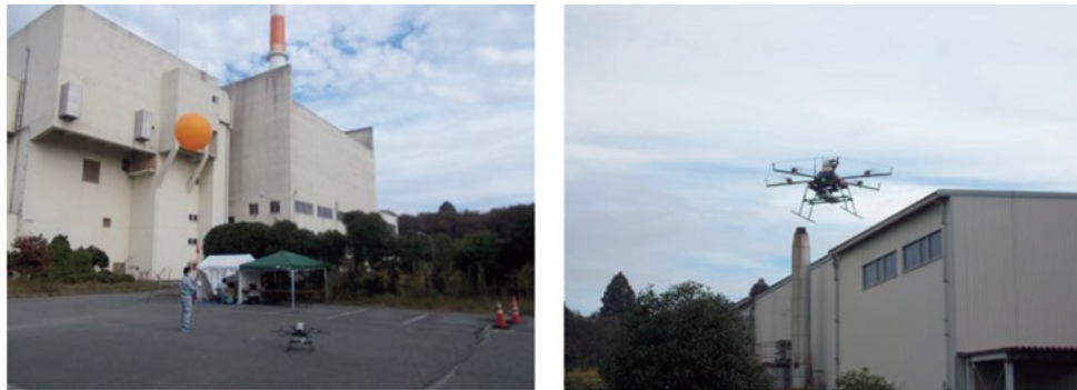
図7 GPSゾンデとドローンの調査風景
