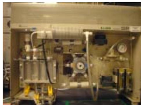
写真1 金アマルガム捕集加熱気化冷原子吸光法による装置
