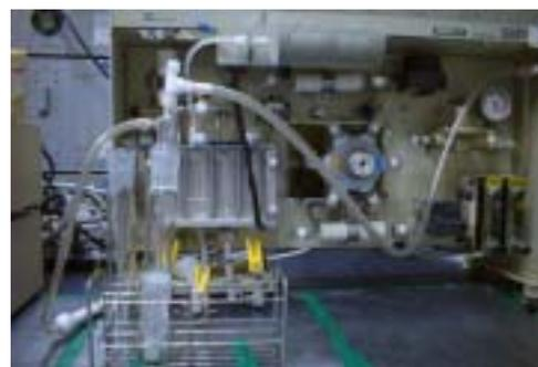
写真2 還元気化原子吸光光度法による装置
