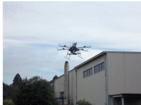
図7 GPSゾンデとドローンの調査風景
