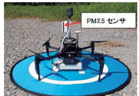
図12 PM2.5センサ搭載ドローン
