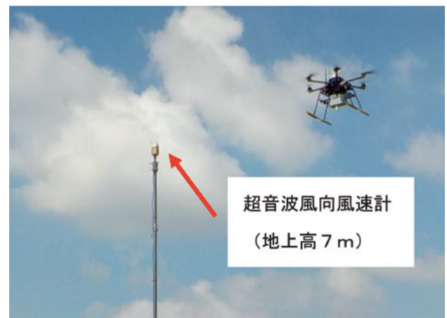
図4 超音波風向風速計との並行測定の様子
