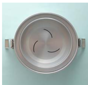
スリット型ジェットノズル (粒径 2.5 \mu\text{m} 、50%カット) フィルタ捕集面 (粗大粒子 2.5 \mu\text{m} < D_p < 10 \mu\text{m} )
