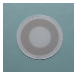
スリット型ジェットノズル (粒径 2.5 \mu\text{m} 、50%カット) フィルタ捕集面 (粗大粒子 2.5 \mu\text{m} < D_p < 10 \mu\text{m} )
