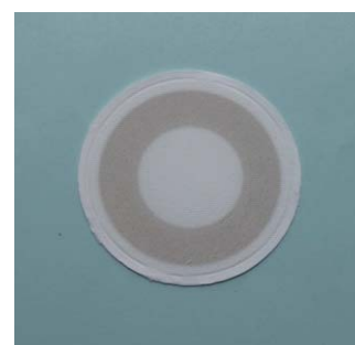
フィルタ捕集面 (粗大粒子 2.5 \mu\text{m} < D_p < 10 \mu\text{m} )
