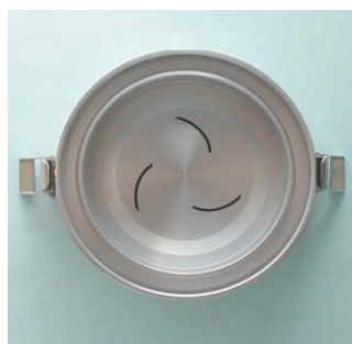
スリット型ジェットノズル (粒径 2.5 \mu\text{m} 、50%カット)
